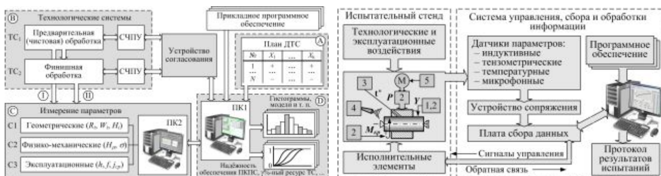
Рисунок 14 – Этапы автоматизации метода ЭДТС и типовая структура автоматизированной системы исследования ЭС соединений деталей машин: 1, 2, 3, 4 – индуктивные, тензометрические, температурные и микрофонные датчики; 5 – исполнительные элементы приводов устройств моделирования воздействий
